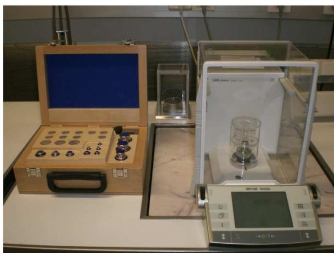
Figura 1- Balança AX 26 e pesos E2.
