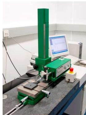
Figura 9 - Esquema de um Rugosímetro e Rugosímetro existente no IPQ.
