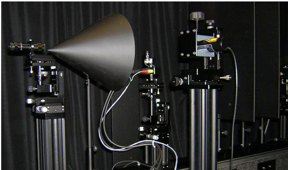
Figura 3. Banco fotométrico do Laboratório de Fotometria do IPQ.
