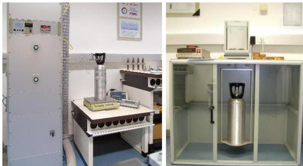
Figura 1 – Instalação de enchimento e balança comparadora.
