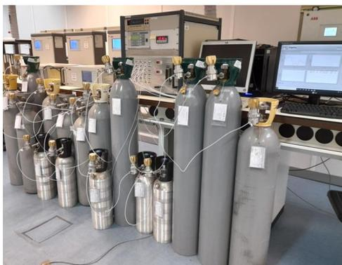
Figura 3 – Instalação de certificação de misturas gasosas por NDIR com sistema de amostragem automático.
