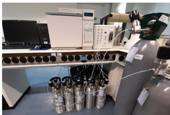
Figura 4 – Instalação de certificação de misturas gasosas por GC-FID.
