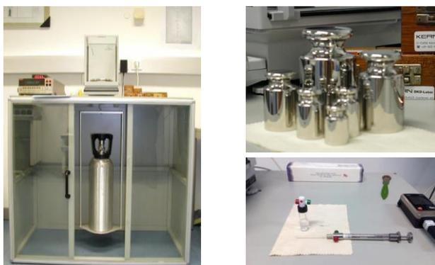
Figura 1 – Balança comparadora com massas rastreadas ao padrão nacional e seringa utilizada para medir e para introduzir o etanol.
