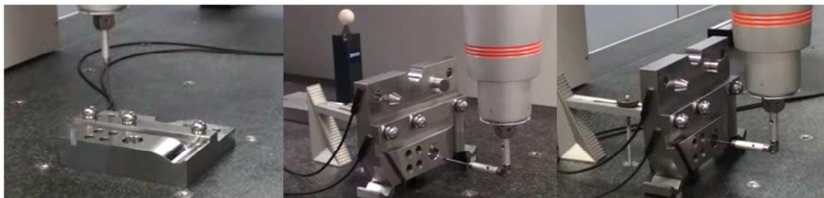
Figura 3 – Artefacto calibrado em CMM de alta exactidão (plano XY, XZ e YZ).
