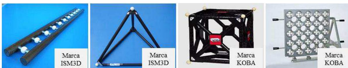
**Figura 1** – Tipo de artefactos calibrados existentes na actualidade.
